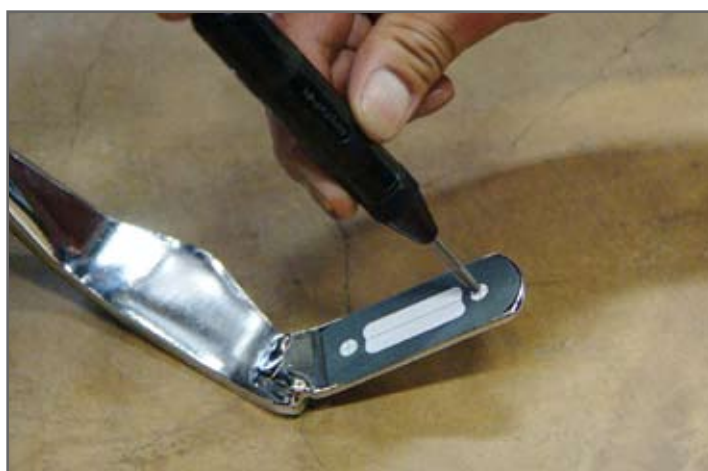
5 テンプレート ⊕ 部にセンターポンチを打ちます。非常に重要な作業です。慎重に、正確に!
