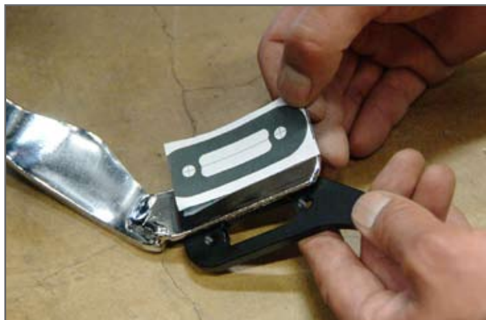
1 付属のテンプレートシールとマウントブラケットをあてがい、位置を確認。
