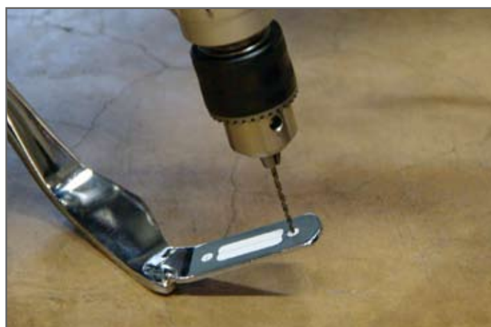
6 ポンチの位置に2mm程度のドリルで穴を開けます。(※いきなり太いドリルを使用するとセンターがずれてしまいますので注意)
