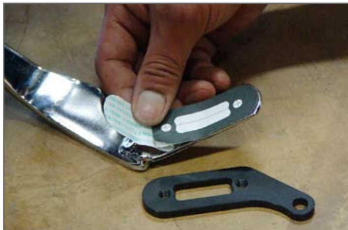
3 スタンド本体にテンプレートシールを貼り付けます。
